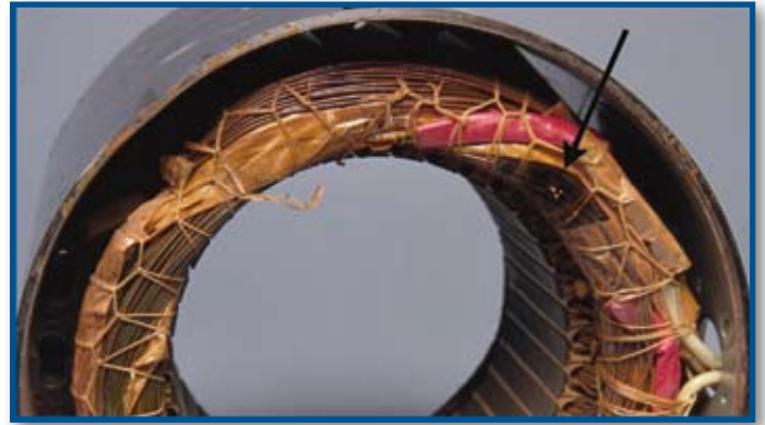
La falla de este bobinado fue causada por sobrevoltaje. ¡Una prueba de aislamiento no lo detectaría!
