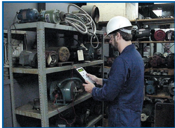
Probando los motores de respaldo para confirmar su estado, asegurando no instalar un motor con falla.
